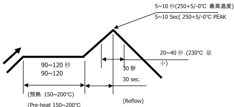
温度条件曲线图/ 基板上温度
